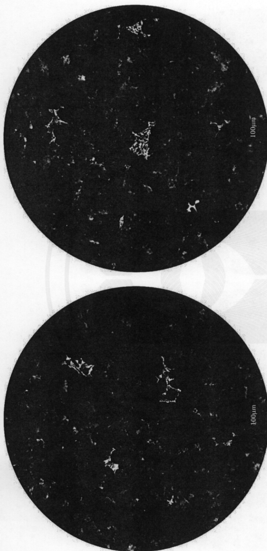
图 I.1 磷共晶含量评级图(100×)(续)
