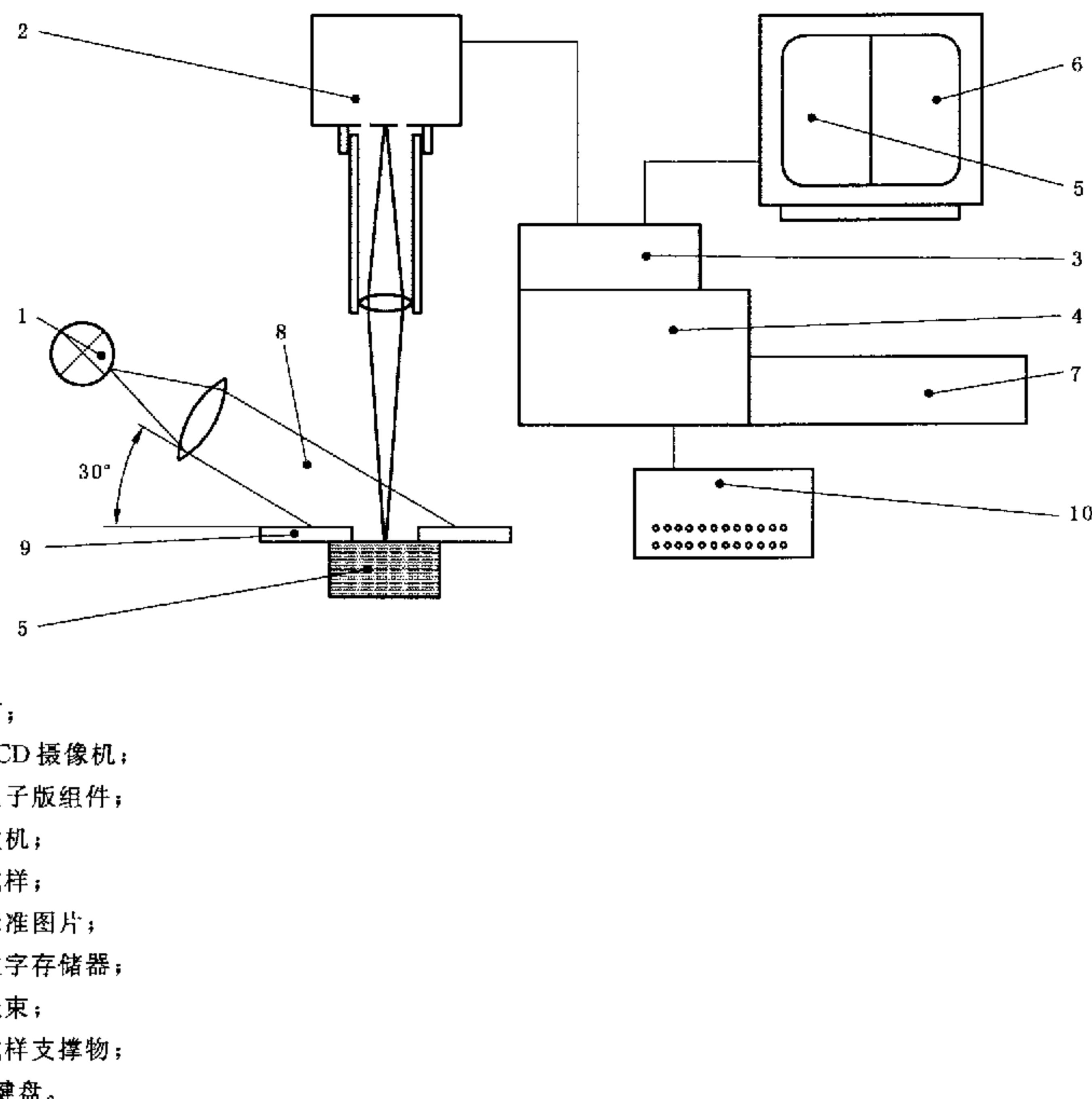
图 2 带 CCD 摄像机的方法 B 和方法 D 使用的设备
