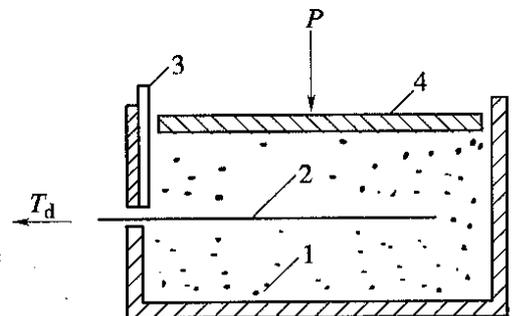
图 T 1130-1 拉拔试验箱示意图
