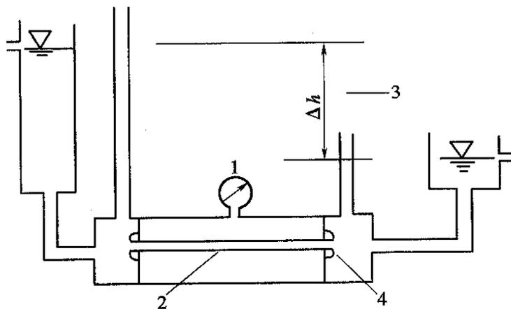
图 T 1143-2 卧式通水能力测定仪
