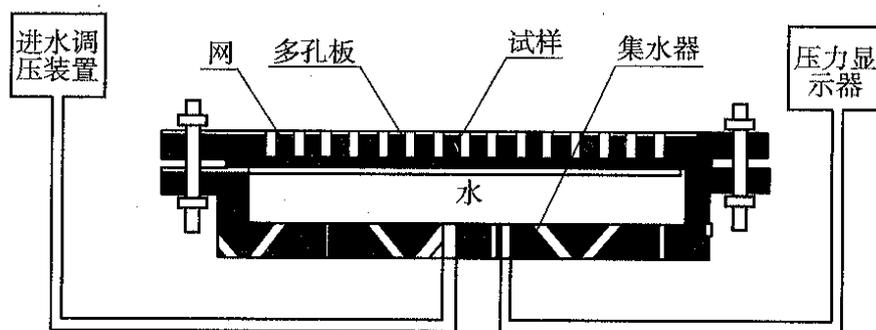
图 T 1142-1 耐静水压装置示意图
