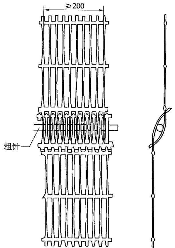
5.5 试样调湿和状态调节:按本规程 T 1121— 图 T 1122-2 土工格栅试样图(尺寸单位:mm)
