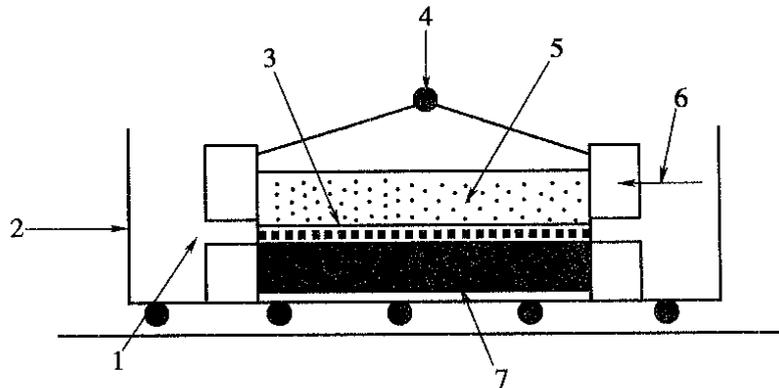
图 T 1129-2 接触面积递减直剪仪示意图
