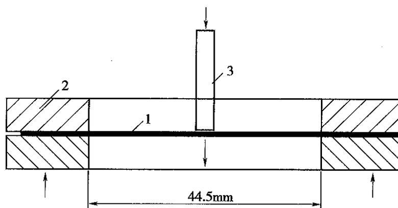
图 T 1127-1 刺破试验示意图
