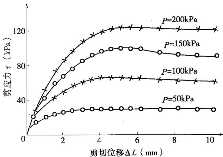
图 T 1129-3 剪应力与位移关系曲线
