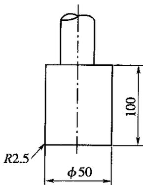
图 T 1126-2 顶压杆(尺寸单位:mm)
