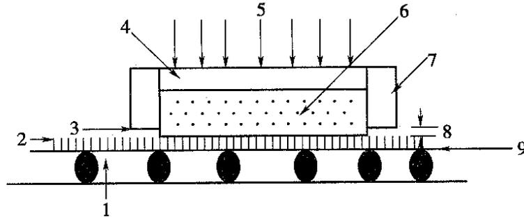
图 T 1129-1 接触面积不变直剪仪示意图
