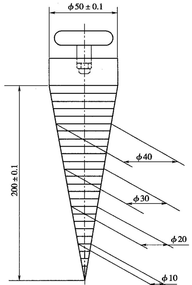
图 T 1128-2 量锥示意图(尺寸单位:mm)
