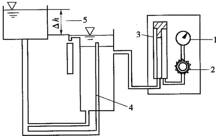
图 T 1143-1 立式通水能力测定仪
