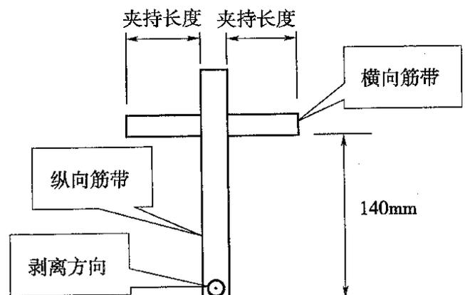
图 T 1124-1 剥离试样示意图
