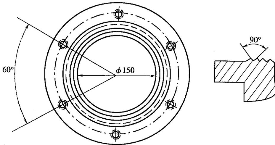
图 T 1126-1 夹持设备(尺寸单位:mm)
