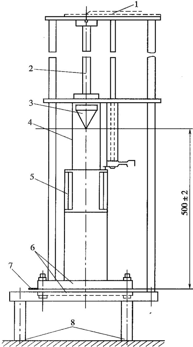
图 T 1128-1 落锥架示意图(尺寸单位:mm)
