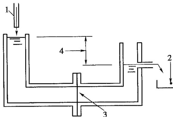
图 T 1141-1 水平式恒水头渗透仪示意图
